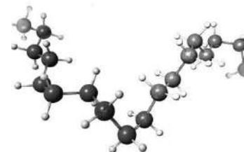
PE100 → Un grade de PEHD avec des **caractéristiques de performances connues et maîtrisées sur le long terme** et qui assurent aux canalisations sous pression **une durée de vie minimale de 100 ans**
