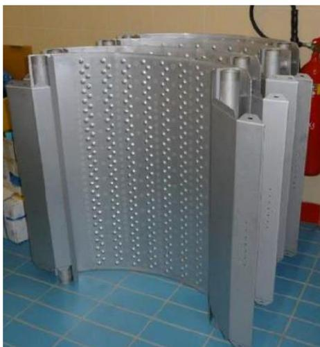
Objectif : lors des rénovations d'égouts, aux endroits appropriés, utiliser des échangeurs de chaleur pour offrir à terme un système de conditionnement d'air aux habitations correctement isolées
