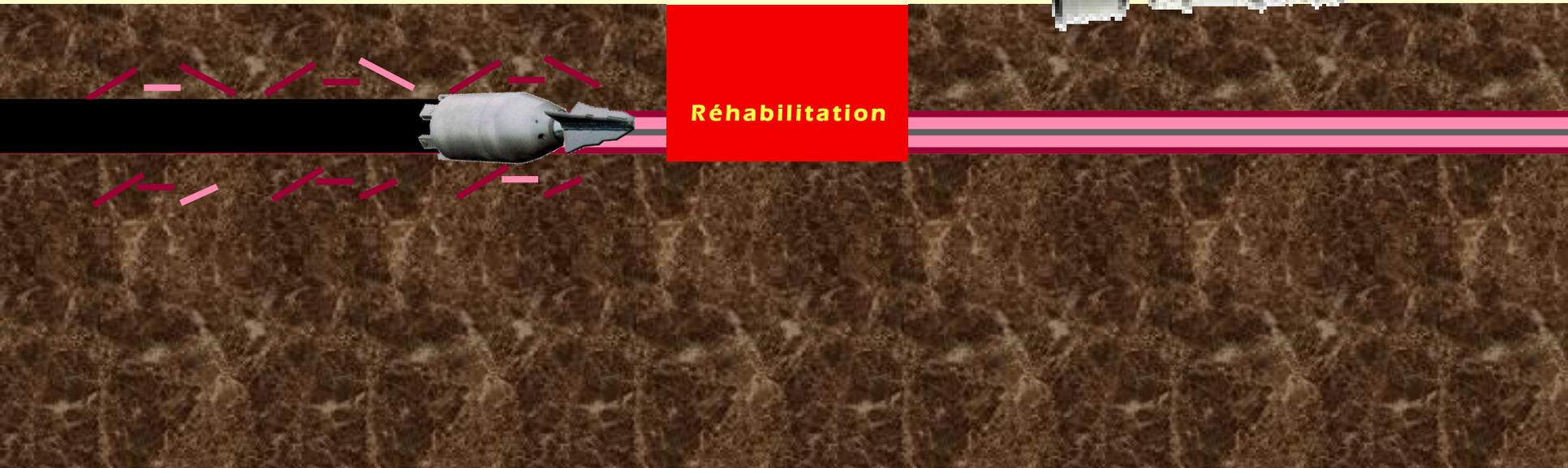
Pendant l'**éclatement** de l'ancienne canalisation, l'**élargissement** pour créer le passage du nouveau tuyau et l'**introduction** de ce dernier, les tiges ou le câble peuvent être installés dans le prochain tronçon
