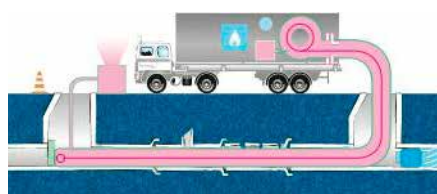
Réhabilitation de canalisation par chemisage
