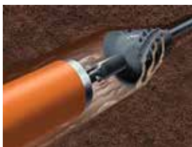
Alésage et tirage de la canalisation lors d'un forage dirigé
