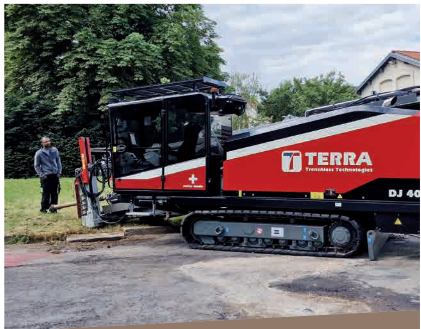
▼ Les fabricants de foreuses dirigées ont fait le déplacement avec des machines de belle taille pour régaler le public du salon, à l'image de Terra et sa DJ40 de 18/20 t et 175 ch.
