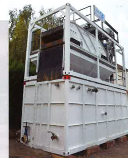
Un système complexe de gestion des fluides de forage est nécessaire pour la mise en œuvre du tunnelier.
