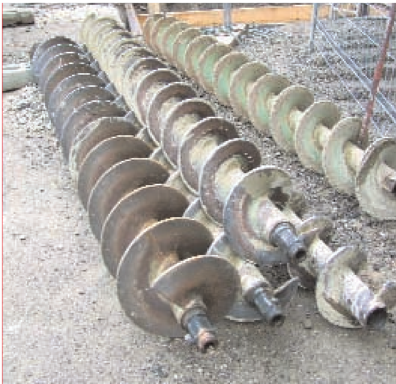
Les tarières, pour la purge de la canalisation.
