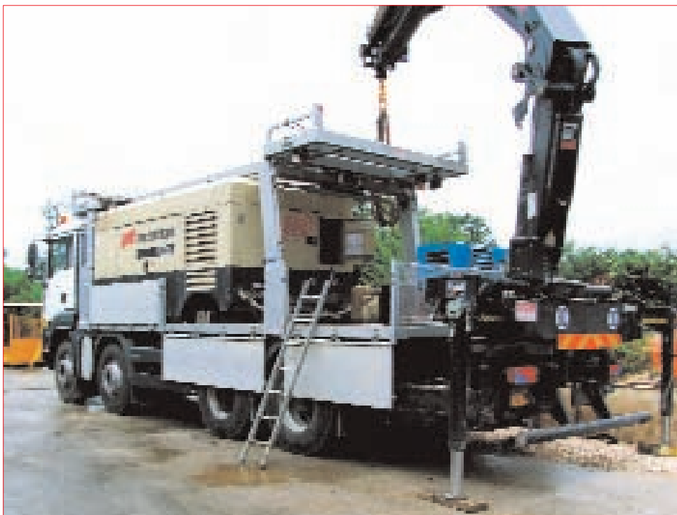
Le camion, avec le compresseur, la grue et les centrales d'énergie.
